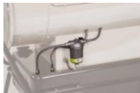
Brennstofffilter med forvarmer
